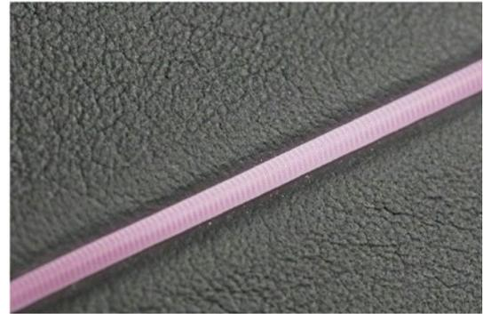
**BILD 2** Schnittgrafik (links) und derzeitiges Foto (rechts) des kaschierten rosafarbenen Paspol-Lichtleiters in einer grauen Lederoberfläche (© Dräxlmaier)
