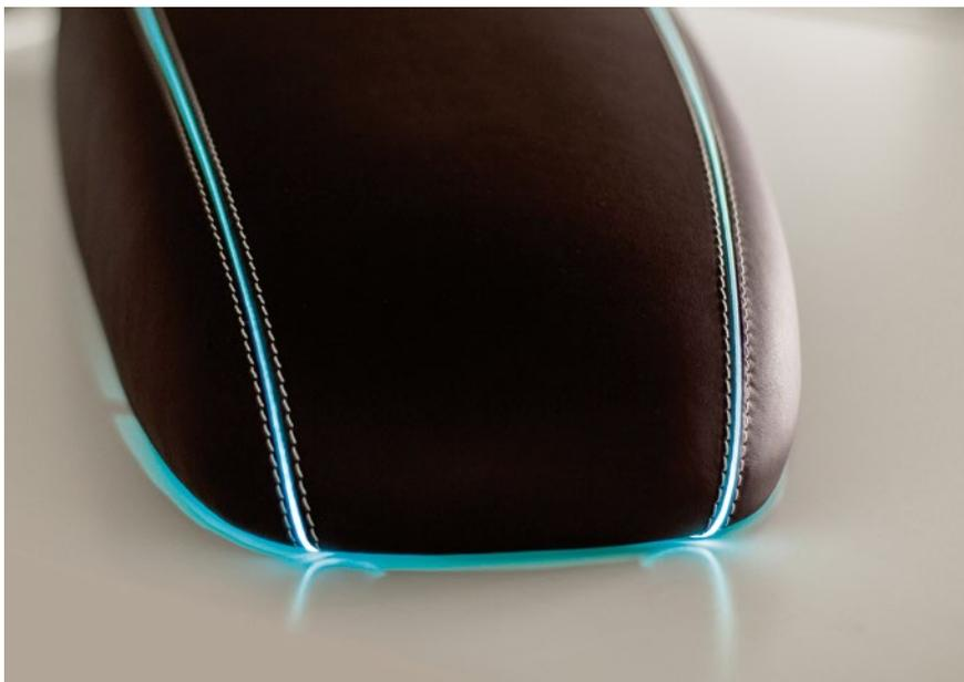
**BILD 4** Armauflage einer Konzept-Mittelkonsole mit zwei Paspol-Lichtleitern, welche die geschwungene Form und Exklusivität des Interieurs betonen (© Dräxlmaier)
