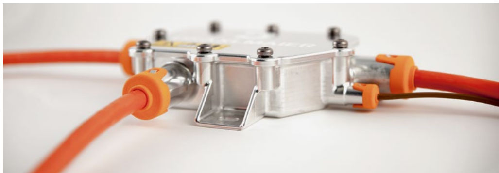
BILD 6 Anzahl und Abstand der Verschraubungen basieren nicht etwa auf mechanischen Anforderungen, sondern dienen im Wesentlichen der EMV
