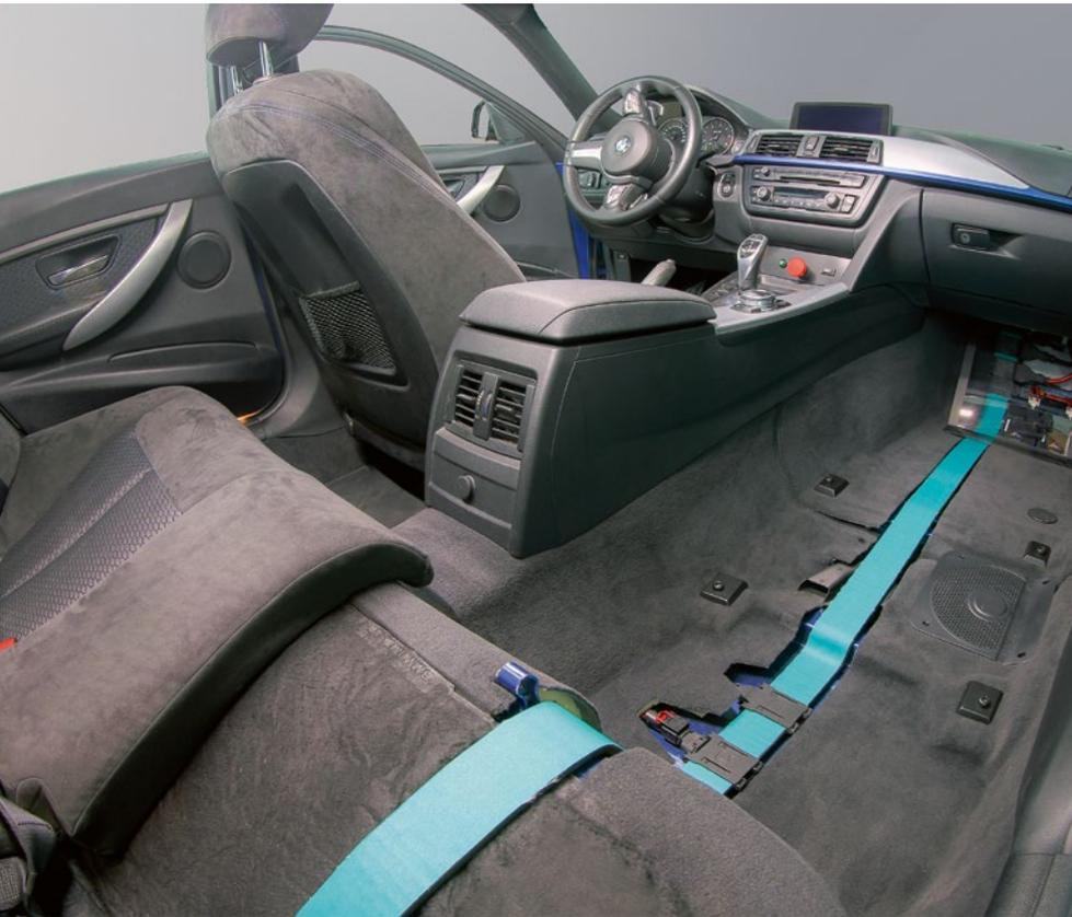
**BILD 5** Einsatz von Stromschienen und elektronischen Stromverteilern im Dräxlmaier Smart KSK (Kundenspezifischer Kabelbaum) © Dräxlmaier
