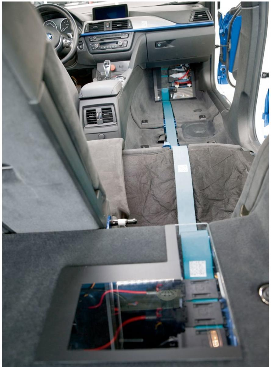
**BILD 1** Die dreilagige Multischiene im Technologieträger Dräxlmaier smart KSK inklusive der vorderen und hinteren Anschluss technik (© Franz Haslinger | Dräxlmaier)
