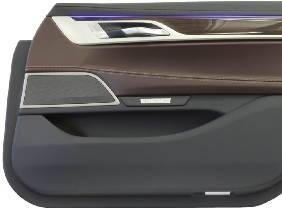
BILD 3 Farbenspiel – Demonstration des dynamischen Lichtlaufs bei millionenfachen Farbmöglichkeiten am Präsentationsmuster Türverkleidung (© Dräxlmaier)
